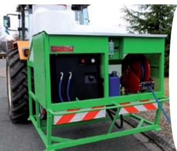
• **Principe** : Ce procédé est basé sur une forte température de l'eau (environ 100°C), l'eau chaude est pulvérisée sous forme liquide sur la végétation à détruire. L'eau chaude appliquée directement sur la plante provoque la coagulation des protéines végétales et l'arrêt de la photosynthèse de la plante donc sa destruction. L'eau est chauffée grâce
