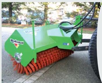
• **Principe :** Cette technique utilise plusieurs brosses métalliques souples à axe vertical ou horizontal. Les brosses décantent la couche superficielle sur laquelle poussent les plantes indésirables ce qui a pour effet de déchiqueter et/ou d'arracher ces plantes.
