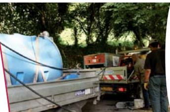
• **Principe :** Ce procédé utilise de l'eau et un additif biodégradable (Foam) à base d'amidon de maïs et de noix de coco. L'ensemble est chauffé afin d'appliquer une mousse chaude (96°C) sur la végétation à détruire afin de réaliser un choc thermique sur la plante entraînant ainsi la dénaturation des ses
