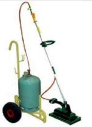
• **Principe** : L'appareil fonctionne au gaz propane en phase liquide ou gazeuse. La réflexion des rayons infrarouges se fait grâce à un carter alvéolé. La température est d'environ 1000° C. Les rayons infrarouges vont provoquer la destruction de la plante par un choc thermique.
