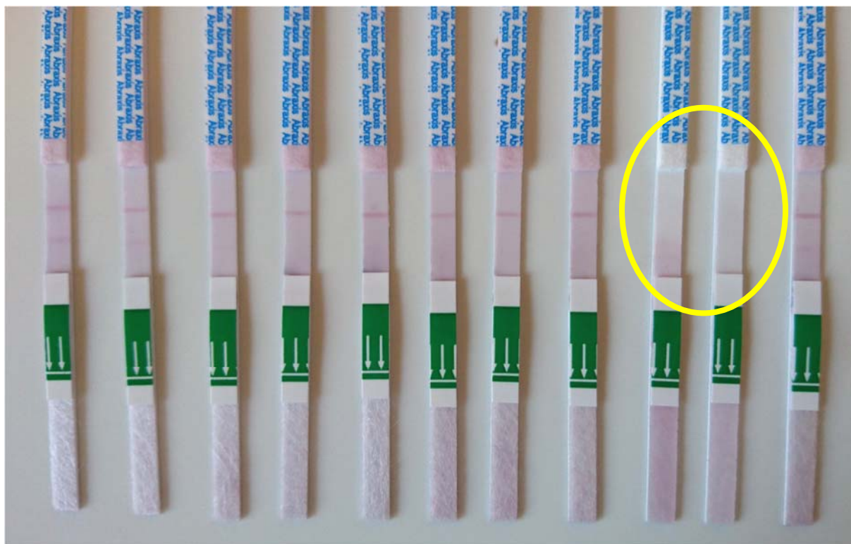
Fig. C17- Autre exemple de bandelettes défailtantes (essai "eaux brutes"). Noter la différence de coloration des zones test et zones tampons sur les bandelettes de droite: la première a absorbé sur 1/3, la seconde n'a rien absorbé.
