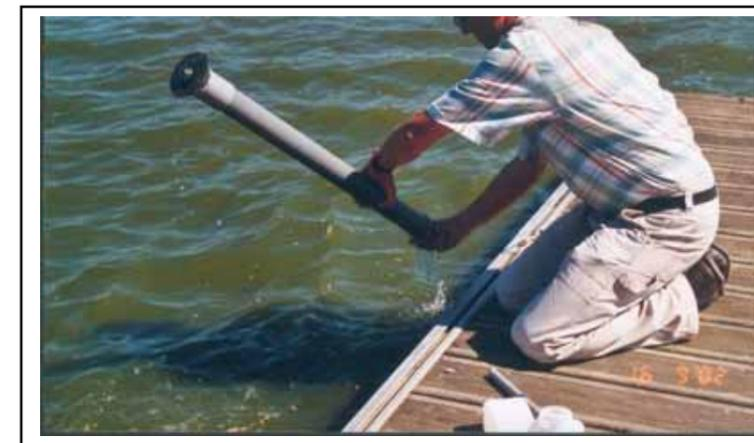
*Prélèvement d'une colonne d'eau pour analyse (DASS)*
